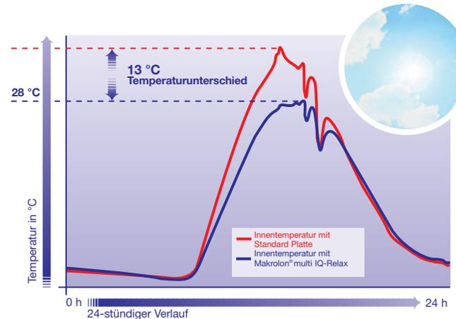
Tests am Beispiel eines unbelüfteten/unbeheizten Wintergartens zeigten eine Reduktion im Innenraum um bis zu 13°C im Vergleich zu Standardplatten. Das bedeutet: höchste Selektivität egal welches Wetter draußen herrscht.
